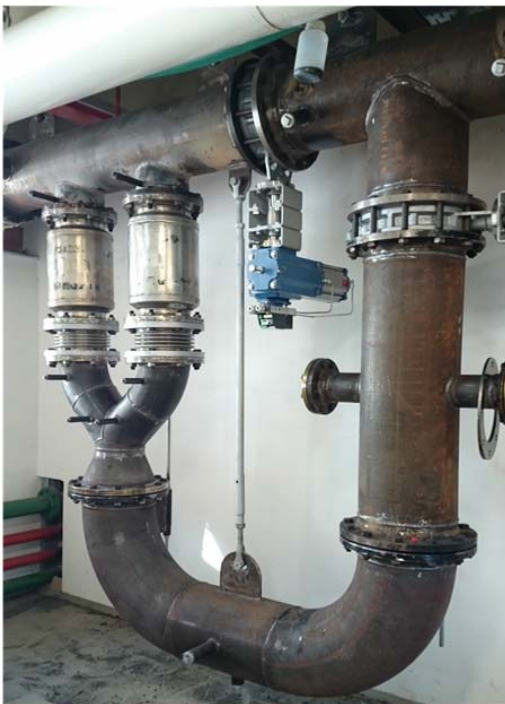
Εικόνα 4. Η πειραματική διάταξη μεταβλητής όδευσης και καθαρισμού καυσαερίων στο ENM. (α) η σωλήνωση όπου διακρίνονται όλες οι επιμέρους συνδέσεις, (β) ο αγωγός στην τελική του μορφή με τη μόνωση.
