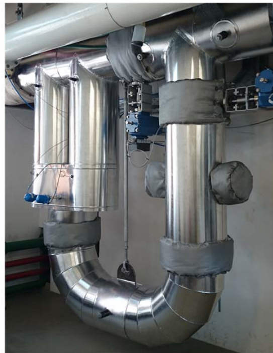
Εικόνα 4. Η πειραματική διάταξη μεταβλητής όδευσης και καθαρισμού καυσαερίων στο ENM. (α) η σωλήνωση όπου διακρίνονται όλες οι επιμέρους συνδέσεις, (β) ο αγωγός στην τελική του μορφή με τη μόνωση.
