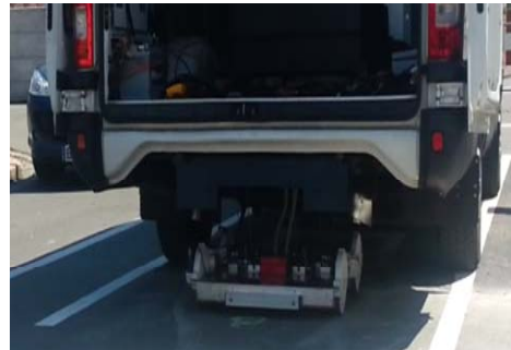
Εικόνα 3: Ο μηχανισμός τοποθέτησης που αναπτύχθηκε στο FastInCharge
