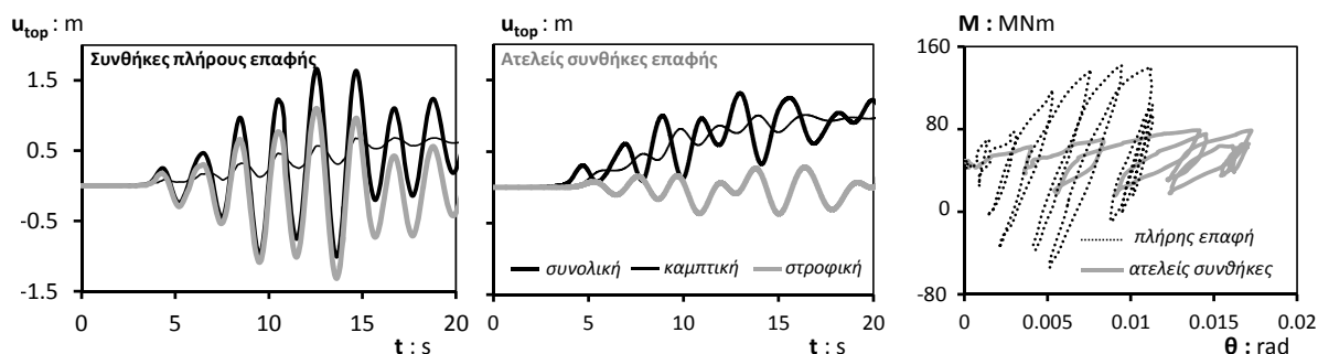
Σχήμα 9. Σεισμική απόκριση ανεμογεννήτριας ισχύος 2 MW θεμελιωμένης σε αργλικό σχηματισμό μέσω ανεστραμμένου κοίλου φρέατος διαμέτρου ( B=16\text{m} , D/B=0.2 ): χρονοϊστορία οριζόντιας μετακίνησης στο επίπεδο του ρότορα και βρόχοι M- \theta στην επιφάνεια του θεμελίου και για τους δύο τύπους διεπιφάνειας.
