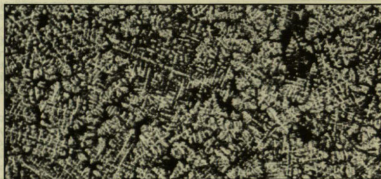
Χαρακτηριστική εικόνα χυτού κράματος Cu - Sn (κρατέρωμα).
