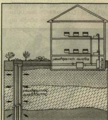
μική ενέργεια του οικοπέδου της (φωτ.1). Η κατοικία αποτελείται από δύο διαμερίσματα, ένα ισόγειο εμβαδού 130 m<sup>2</sup>, και ένα στο πρώτο όροφο, εμβαδού 125 m<sup>2</sup>. Η ισχύς των αναγκών θέρμανσης και ψύξης των δύο διαμερισμάτων, υπολογίσθηκε σε 15 kW.
