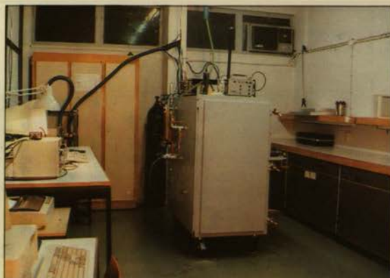
Φωτογραφία 1. Θάλαμος μελέτης της εκπομπής του Ραδονίου
