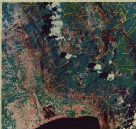
Σύγκριση Κλασικής και Δορυφορικής μεθοδολογίας για την ανίχνευση γεωλογικών ρημάτων. Χρωματική Σύνθεση περιοχής Καλαμάτας στις 29.5.86 με τα κανάλια 7 (κόκκινο), 4 (πράσινο), 5 (μπλε) ενισχυμένη οπτικά με ισοδυναμοποίηση του ιστογράμματος. Εικόνα 1: Κλασική Μέθοδος, Εικόνα 2: Δορυφορική Μέθοδος. (Εργαστήριο Τηλεπισκόπησης).
