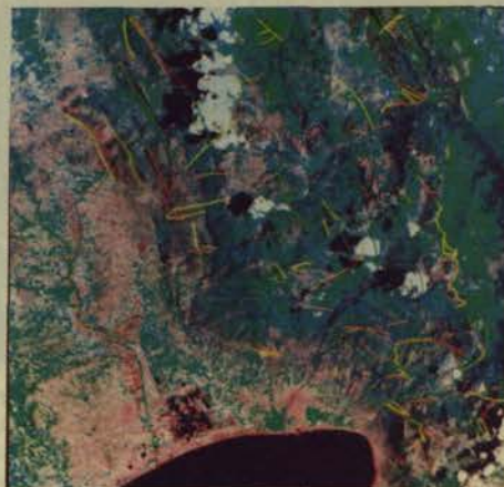
Σύγκριση Κλασικής και Δορυφορικής μεθοδολογίας για την ανίχνευση γεωλογικών ρημάτων. Χρωματική Σύνθεση περιοχής Καλαμάτας στις 29.5.86 με τα κανάλια 7 (κόκκινο), 4 (πράσινο), 5 (μπλε) ενισχυμένη οπτικά με ισοδυναμοποίηση του ιστογράμματος. Εικόνα 1: Κλασική Μέθοδος, Εικόνα 2: Δορυφορική Μέθοδος. (Εργαστήριο Τηλεπισκόπησης).
