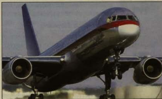
Σχήμα 1: Αεριοστροβίλοι κινήτριες (στροβιλοαντιδραστήρες) σε επιβατικό αεροσκάφος.
