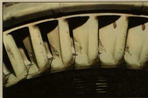
Σχήμα 6: Πτερύγια στροβίλου με επιφάνεια καλυμμένη με επικαθίσεις από πρόσθετο καινούριο.
