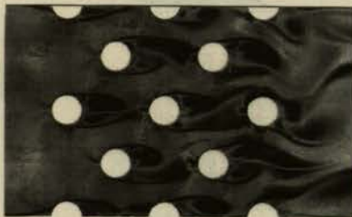
Σχήμα 12β: Περιοχές ισο-στροβιλότητας στη μετατοπισμένη διάταξη κυλίνδρων.
