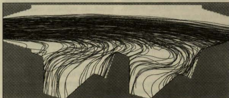
Σχήμα 8: Τροχιές σωματιδίων εντός δοχείου καθίζησης.
